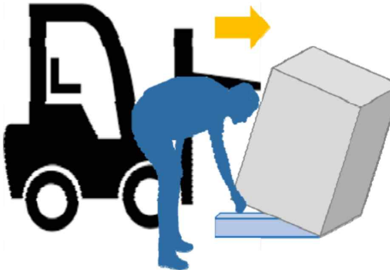
지게차 포크로 콘크리트블록을 밀어 기울인 후 고임목 설치 시도
